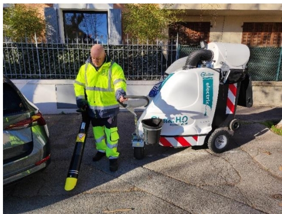
Figure 5 : Aspirateur de voirie « glutton »
